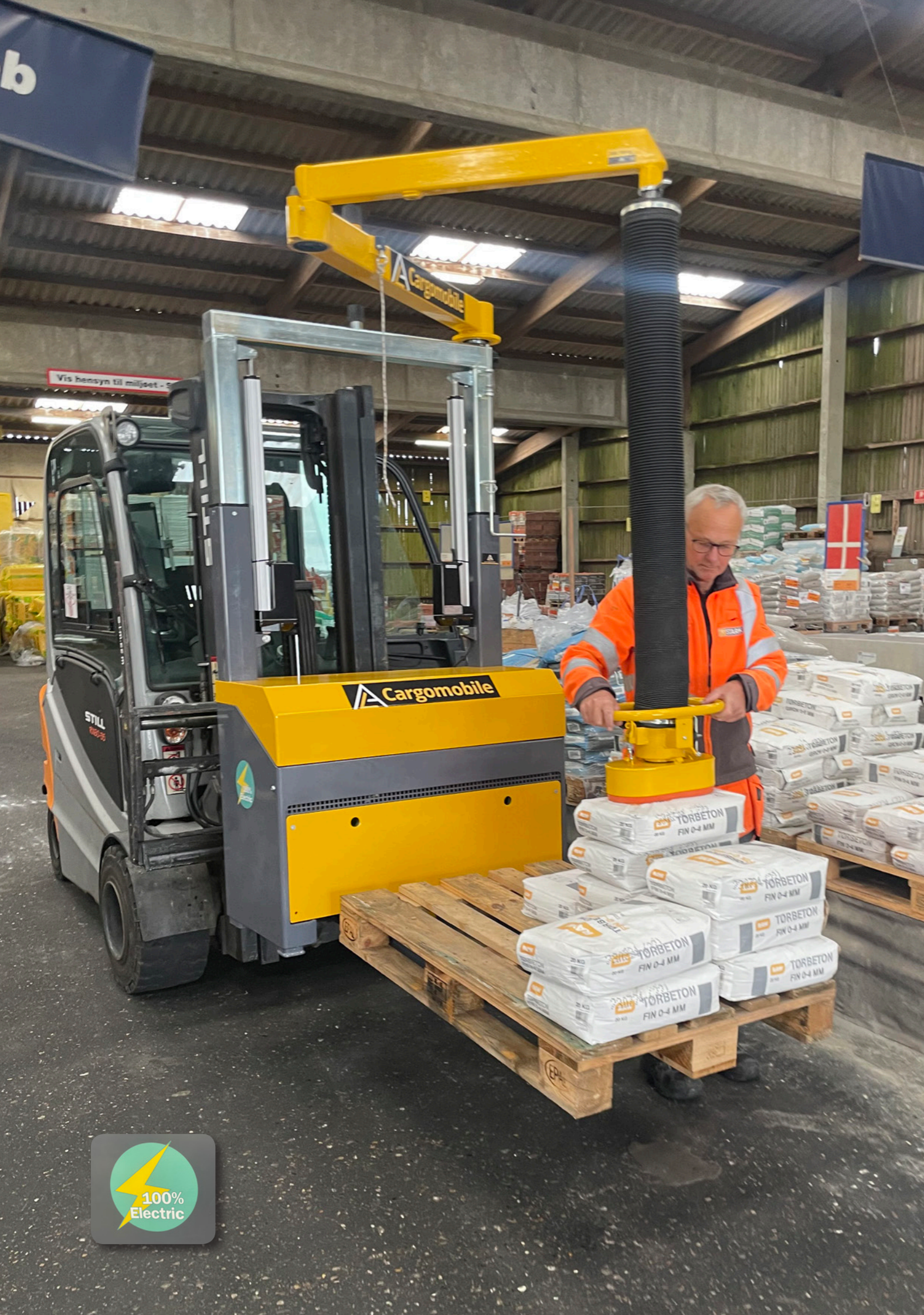
Front panelet kan afmonteres så man kan skifte batterikassen på få minutter
