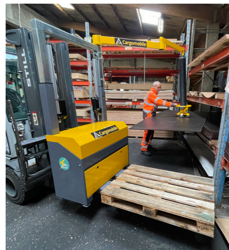
Front panelet kan afmonteres så man kan skifte batterikassen på få minutter
