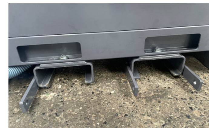
Udskiftelige gaffellommer indv. mål - 190 mm brede, 70 mm høje. Hver gaffel kan justeres med 170 mm
